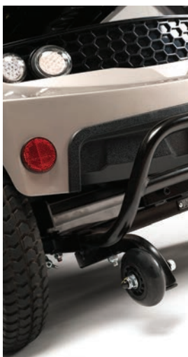
Anti-tipping wielen, voor- en achterlichten en extra reflectoren
