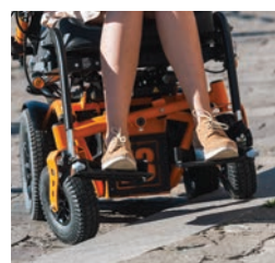
Roterende as voor constant grondcontact op alle wielen
